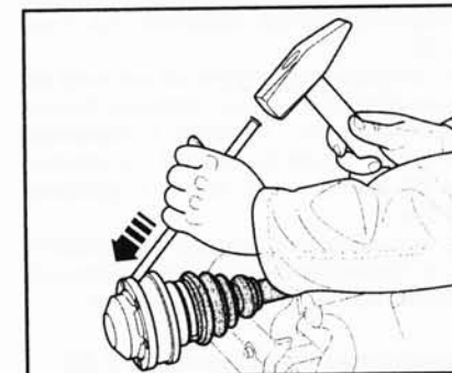
4.17 Снятие крышки шарнира VL107
